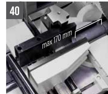
TIGER 352 NC 5.0 Morsa especial de redução de refugo
