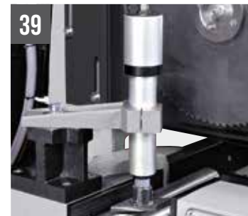
TIGER 352 MA / COBRA 352 MA Morsa vertical pneumática
