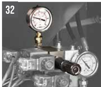
SHARK SXI evo Regulador de pressão da morsa hidráulica
