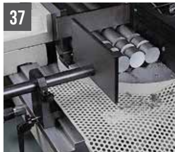
SHARK 282 NC 5.0 / 332 NC 5.0 Guia regulável para a descarga das peças
