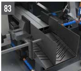
83 Guia regulável para descarga de peças
