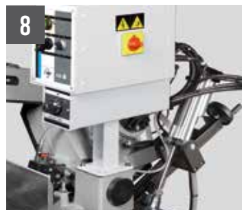
8 SHARK 282 - KIT CCS Cut Control System (système pour coupe sans opérateur)
