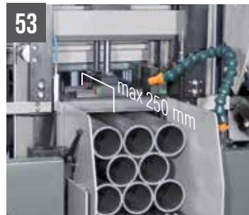
53 SHARK 230-1 NC HS 5.0 Étaux verticaux hydrauliques pour coupe en paquets (max 230X230 mm)
