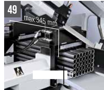
49 SHARK 281 NC 5.0/282 SXI evo Étaux verticaux hydrauliques pour coupe en paquets (max 170x130 mm)
