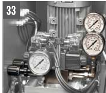
SHARK NC 5.0 Régulateur pression étaux hydrauliques
