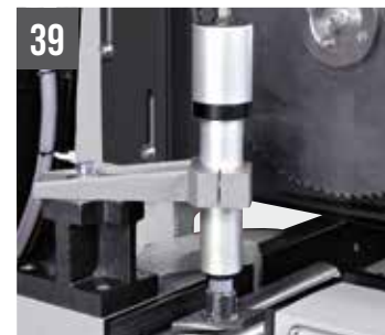
TIGER 352 MA/COBRA 352MA Étau vertical pneumatique
