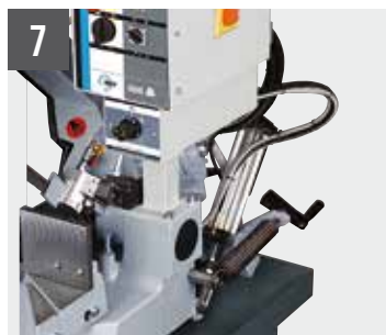
7 SHARK 281 - KIT CCS Cut Control System (système pour coupe sans opérateur)
