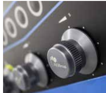
68 TIGER 352 NC 5.0 Stufenlose Drehzahlregulierung 15÷150 U/ min - inkl. 5,5 kW Frequenzumrichter
