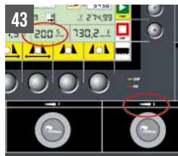
SHARK 350 CNC HS 4.0 / 350 NC HS 5.0 KIT velocidad de la hoja 15÷200 m/min
