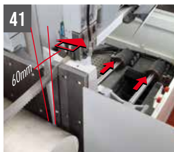
SHARK 660 CNC HS 4.0 - Mordaza de corte con placa posterior de retroceso
