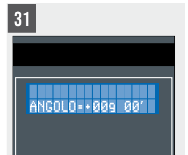
31 SHARK 512 SXI evo Visualización ángulo de corte
