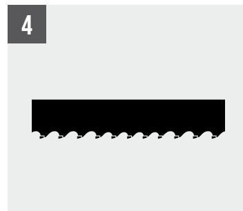
Cinta con dientes de matel duro electrosoldados
